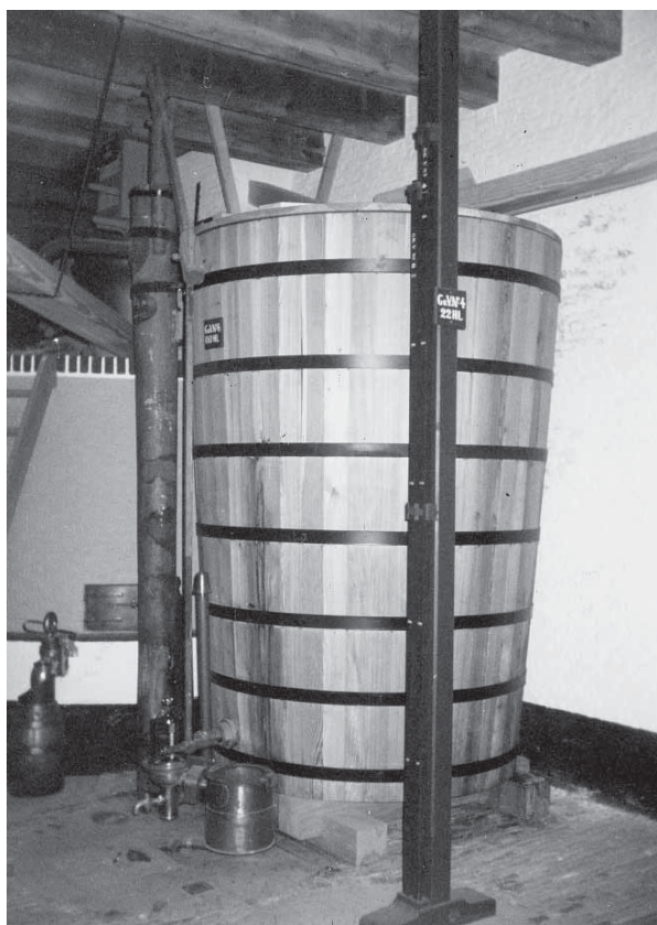
Koelvat dat in verbinding stond met de distilleerketel. De op de achtergrond zichtbare buis staat in verbinding met het grondvat, waarin de moutwijn/jenever werd opgeslagen.
