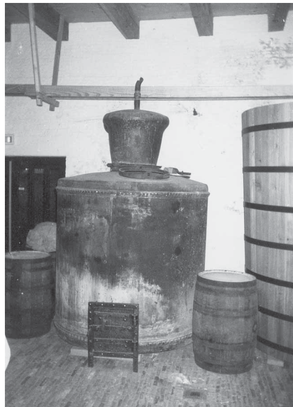
Ketel voor inmetseling. Bovenop is duidelijk de zogenaamde helm zichtbaar.
